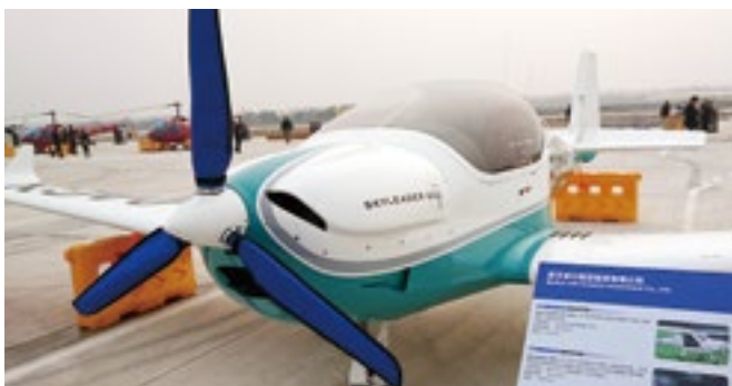
26、捷克的 skyleader 600 轻型飞机，已经与中航工业签约引进国内，将落地四川自贡生产制造。采用的是一台 100hp 的水平对置活塞发动机（无 turbo），发动机品牌为庞巴迪旗下的 Rotax，其在轻型飞行器的全球市场占有率达到 80%，后面还会多次看到。
