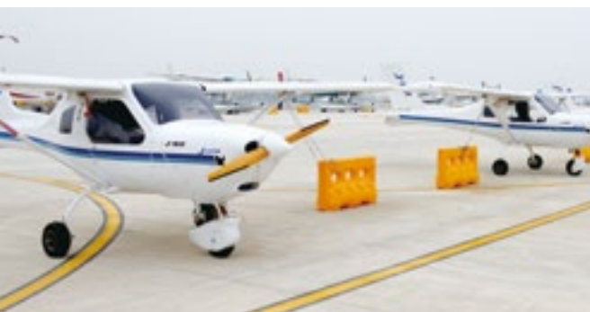
27、佳宝 J160，澳大利亚的轻型飞机，主要机身结构采用玻璃碳纤维复合材料，上单翼设计最适合遮挡阳光照射，空重 295 公斤，最大的特点是自研的发动机。轻型飞行器大多使用普通汽车汽油，95 号就可以。而一般标准的活塞发动机飞机、直升机都使用 100LL 航空汽油，每吨价格上万。再高级的涡轮螺旋桨发动机和涡轮风扇发动机使用的是航空煤油，价格较便宜些，每吨大几千。所以，轻型飞行器在燃油经济性上有着无可比拟的优势，油耗也低，每小时不到 20L。
