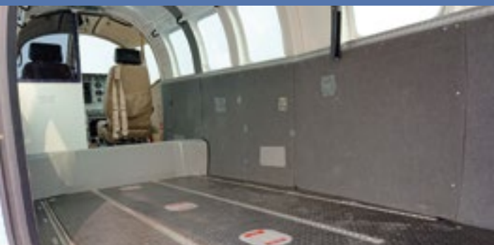
45、几乎没有什么装饰的客舱，就是一款单纯为了运输而生的机型，拉人拉货都是运输。前两天我国研发的 AT200 无人机，就是直接采用这款机型改装的。无人机的优势不光是省了飞行员的成本，还因不涉及人员上天能够大大缩短适航取证的事件，快速推向市场。京东、顺丰都在布局大型无人运输机的研发。
