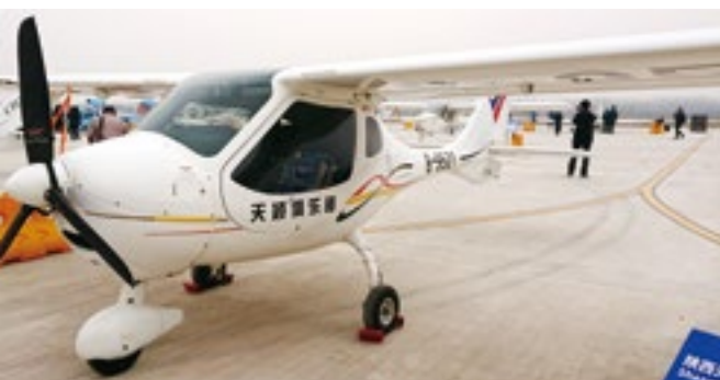
23、CTL5，德国 Flight Design 生产的运动型飞机，看起来虽然不太炫酷，但座舱是碳纤维材质，并具有整机降落伞。
