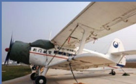
48、一代神机运 -5，生产于上世纪 50 年代，按照前苏联安东诺夫设计局设计的安 -2 飞机的图纸资料制造，是中国人第一个能够完全自主制造的飞机，一共生产了一千多架，在那个特殊年代它的身影遍及中国的各个飞机应用单位。可以说所有空降兵都飞过运 5，现在逐渐被运 12E 军用版所替代。
