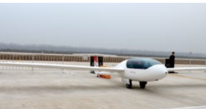
25、斯洛文尼亚蝙蝠飞机制造厂生产的滑翔机，单发并列双座，发动机可收放，可自行起飞不需要牵引，并具有有机载降落伞。
