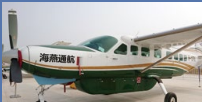
46、赛斯纳 208，机腹部加装了行李舱，连续的这几款多用途飞机的定位一致，售价差不多，2000 万上下。双发的运 12E 价格在 3000 万左右。这几款飞机用的都是 PT6 系列涡轮轴发动机。
